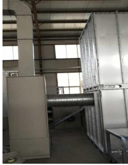
喷塑工序滤芯除尘+布袋除尘
